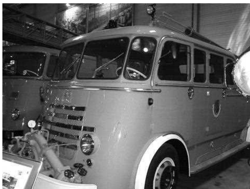
De DAF met voorbouw pomp en 102 pk benzinemotor, rijdend op zes wielen, in het DAF-museum in Eindhoven. De opbouw is van de fa. Bikkers uit Rotterdam. Foto Frits van Lochem
