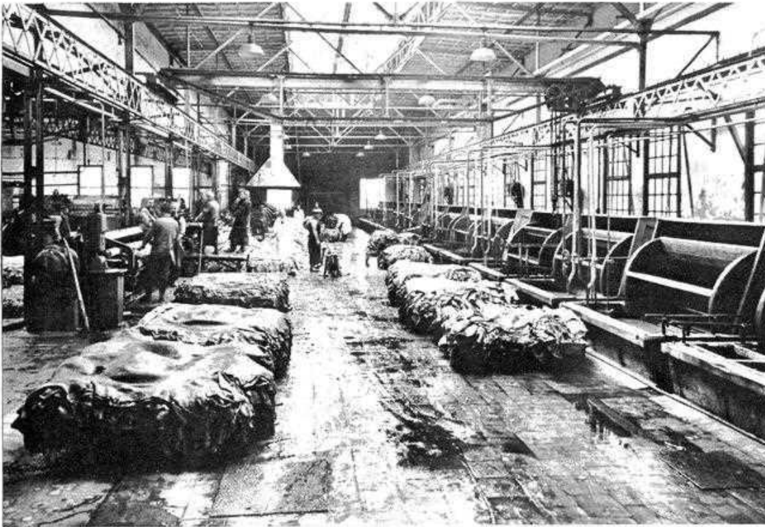
Interieur van de natte afdeling van looierij H.A. Hulshof & Co (omstreeks 1950). Rechts de ontharingskuipen en links de machines voor het ontvlezen en splitten van de huiden.
