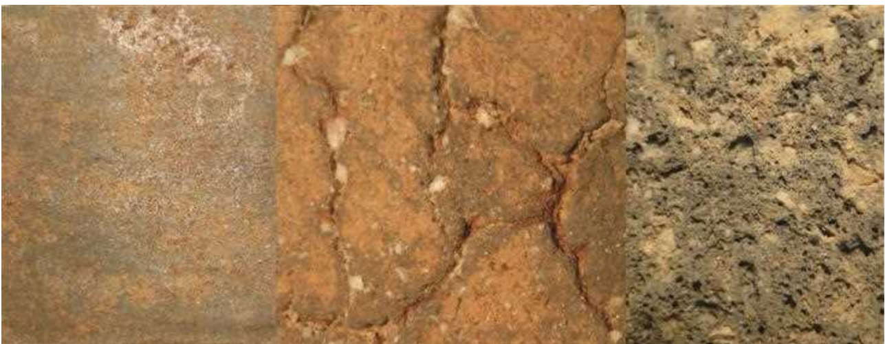
Figuur 14 Verschillende stadia van oververhitting (links normaal gebakken, midden licht oververhit en rechts sterk oververhit).
